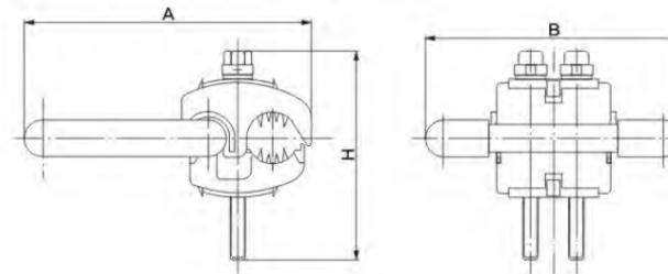
绝缘穿刺接地线夹应用图例
