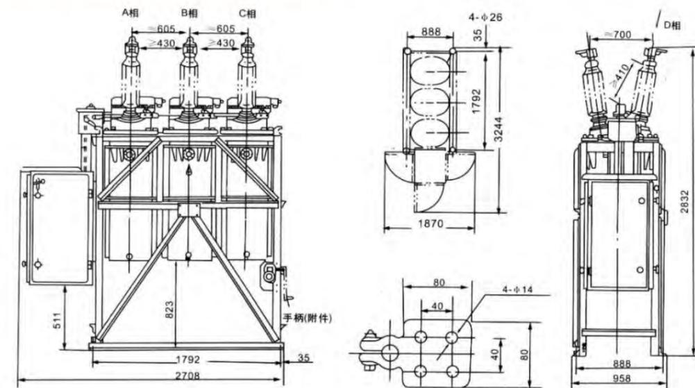
接线夹尺寸图(D向旋)
