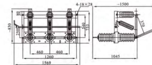
GN27-35C隔离开关外形安装尺寸
