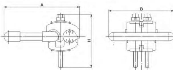
绝缘穿刺接地线夹应用图例
