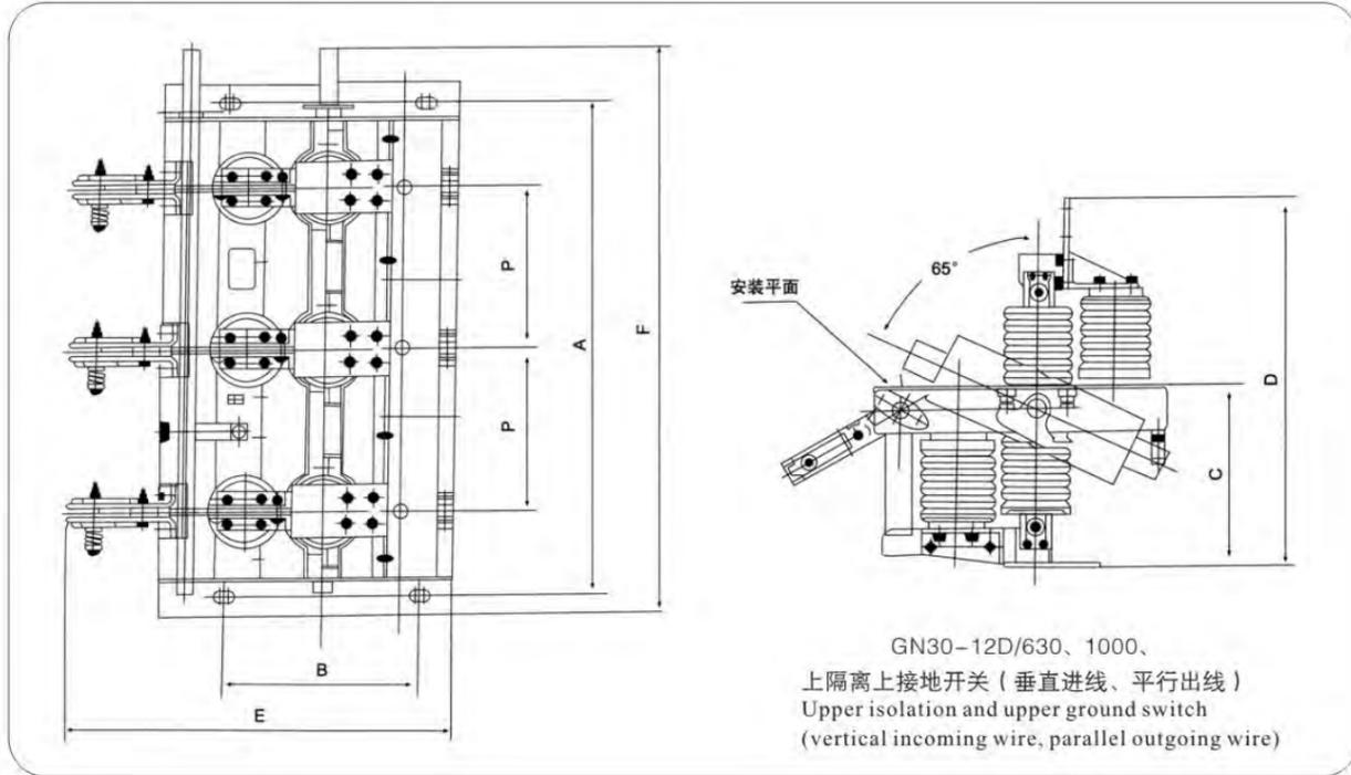
**主要技术安装外形尺寸表(A、B为安装尺寸, C、D、E、F为外形尺寸)**
