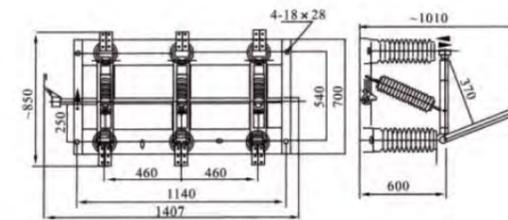
GN27-35隔离开关外形安装尺寸
