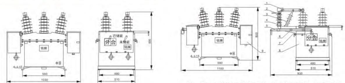
图1 ZW8-12配电子PT断路器外形及安装尺寸图
