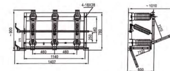
GN27-35D隔离开关外形安装尺寸
