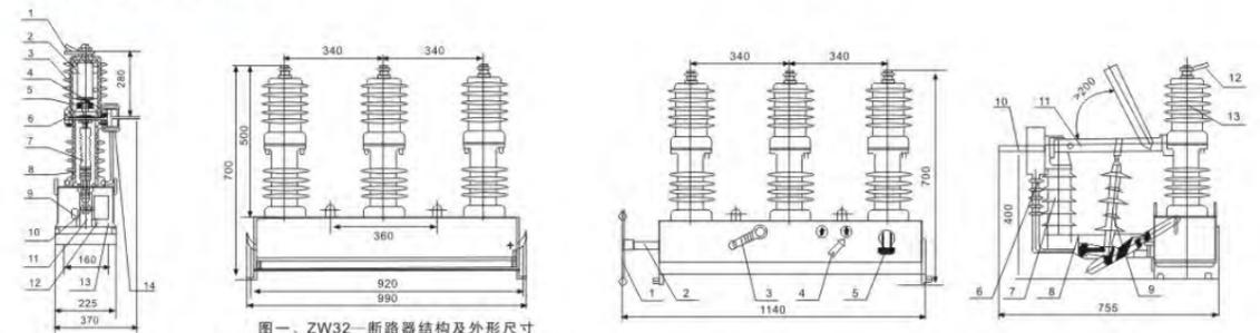
图一、ZW32-12断路器结构及外形尺寸
