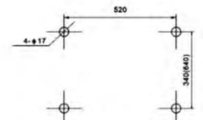
图3 断路器安装尺寸
