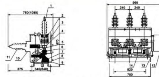
1-导电杆绝缘套管组合体 2-真空灭弧室 3-绝缘隔离罩 4-导电夹 5-软连接
